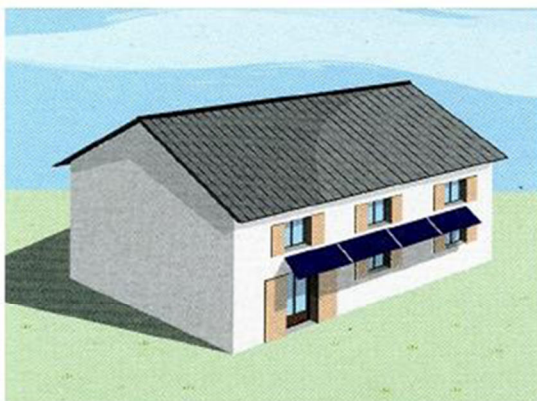
Les capteurs forment un auvent qui crée une ombre portée sur les fenêtres du rez-de-chaussée en été
